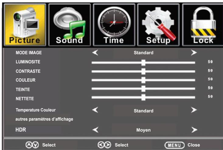
Utilisez les boutons de navigation gauche et droit de la télécommande pour passer d'un élément à l'autre, et les boutons de navigation haut et bas pour sélectionner les options de menu. Pour revenir du contenu du menu aux éléments du menu, appuyez sur le bouton "Menu". Appuyez sur le bouton "Retour ←" pour quitter l'écran de menu.
